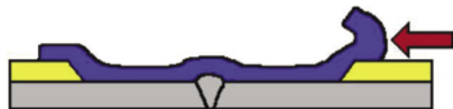
Принцип восприятия нагрузки изоляцией стыка: слева – традиционная изоляция с «выступом», справа – покрытие DENSOLID HDD
